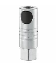
Filetage femelle BSPP Technologie Pression d'utilisation Débit sous 6 bar G 3/8 Sécurité (anti-coup de fouet) 2 à 16 bar 4120 l/min ( $\Delta P = 0.6$  bar) Ø de passage Température Matière **Point fort** -15°C à +70°C Corps Inox 11 mm Anti-statique
